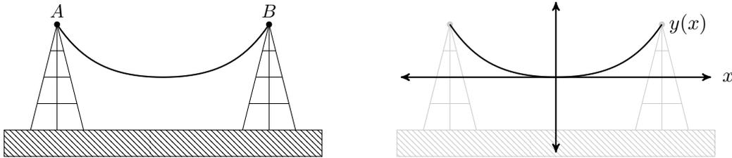
El objetivo de este problema es demostrar que, si colocamos el origen del sistema de coordenadas en la parte más baja del cable, tal como se indica en la figura de la derecha, entonces la forma del cable coincide con el gráfico de la función dada por
