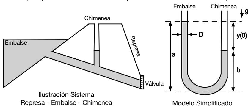
La diferencia de altura  $y(t)$  entre los extremos de la columna de líquido en el tubo con forma de U (en gris), de diámetro  $D > 0$ , largo total entre sus extremos  $L > 0$  y viscosidad  $\nu \geq 0$ , sujeta a una aceleración de gravedad  $g$ , satisface:
